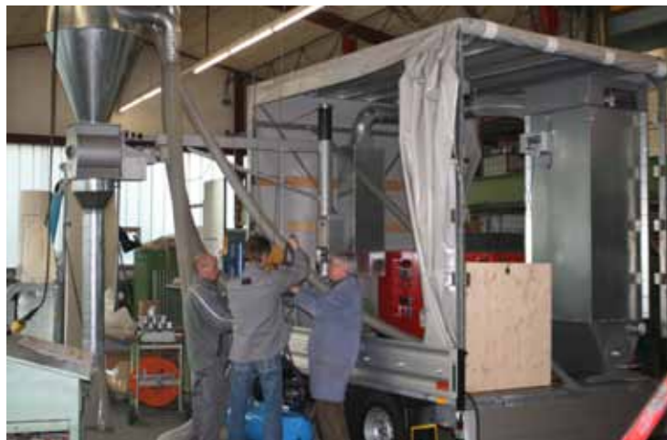
Absauganlage im Testlauf.
